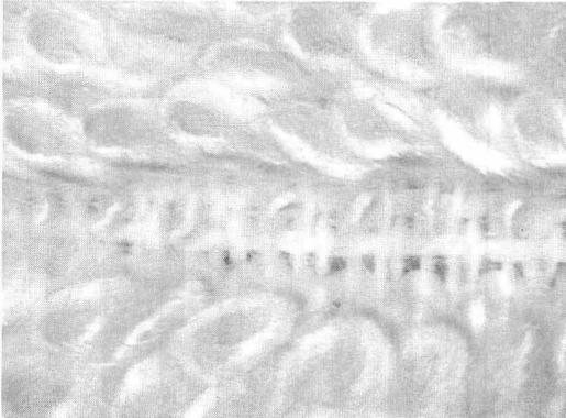
図4 ハンドタオルの基布とパイルがみえる織り表面写真
