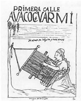
図 1. アンデスの腰帯機 (出典：増田、島田編、古代アンデス美術、岩波書店、1991年発行、p.166)
