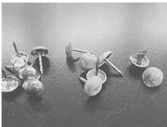
写真5. 新補の鉾と錆付け、朽損した鉾（右）
