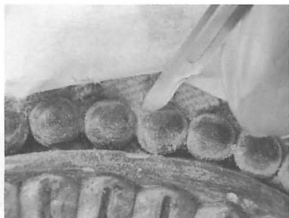
写真4. 真鍮製の鉾に生成した錆の除去
