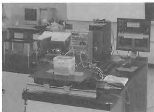
図4 液状化実験装置
