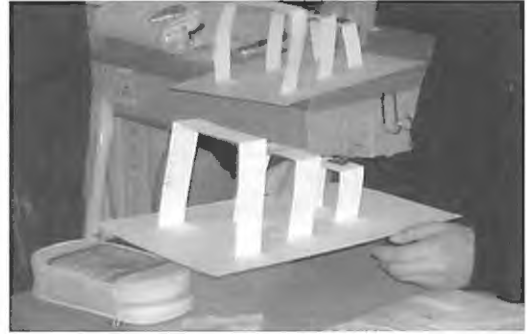
図1 ラーメン構造の共振実験モデル
